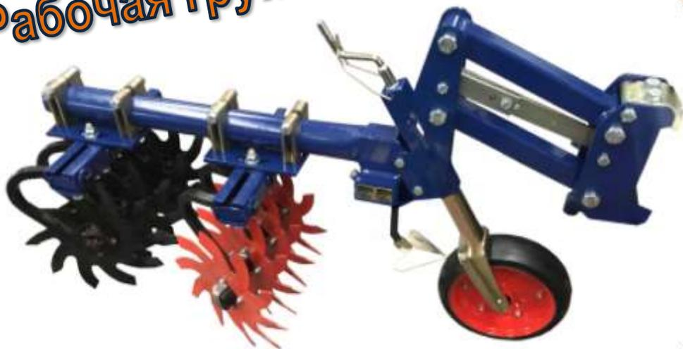
Опционально: на каждом параллелограмме могут быть установлены 2 штуки S-образные стойки 32x12 со стрельчатой лапой 150мм. Опционально могут быть установлены стрельчатые лапы 200мм или 250 мм.
