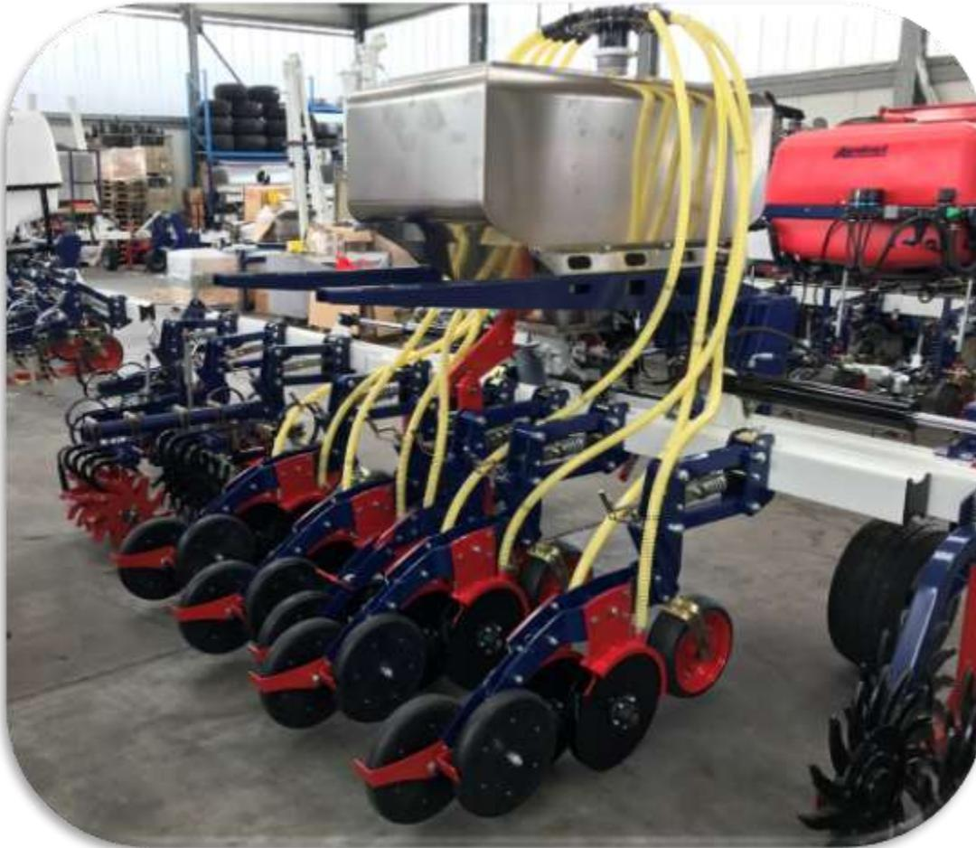
Die Sämaschine kann mit einem System der Einführung des Granulat-Düngers ausgestattet werden, das aus einem Bunker oder je nach Ausführung aus mehreren Bunkern und einem mechanischen System der Düngemiteleinführung besteht.
