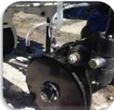
Flüssiges Inoculant befindet sich auf der Sämaschine in Tanks, das vor ultraviolettem Licht geschützt ist und zusammen mit den Samen durch das System direkt in das Saatbett geleitet wird. Das Inoculant wird somit in seiner Wirkung beschleunigt und der Prozess des Absterbens von Bakterien erheblich minimiert.
