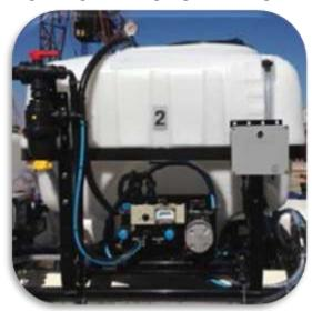
mit Dosierpumpe elektrischem Antrieb. Die Norm der Flüssigkeitseinführung wird von jedem Tank von 50 bis 200 I / Hektar eingestellt. Die Norm Flüssigkeitseinführung wird abhängig von ihrer Dichte wird durch Impulse an der Pumpe eingestellt.
