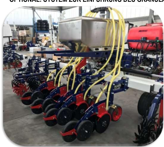
Die Sämaschine kann mit einem System der Einführung des Granulat-Düngers ausgestattet werden, das aus einem Bunker oder je nach Ausführung aus mehreren Bunkern und einem mechanischen System der Düngemitteleinführung besteht.
