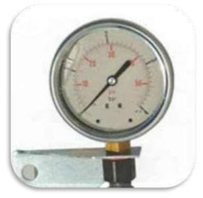
Der Druck im System wird abhängig von der Einführungsnorm mit einem Manometer geregelt und automatisch eingestellt.
