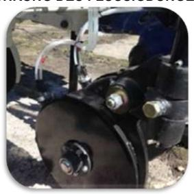
Flüssigdünger aus den Tanks wird mittels individueller Voreinstellung der Doppel-Säscheiben bezogen auf die Saatzeile und der Sätiefe von 5 bis 15 cm in den Boden eingeführt.
